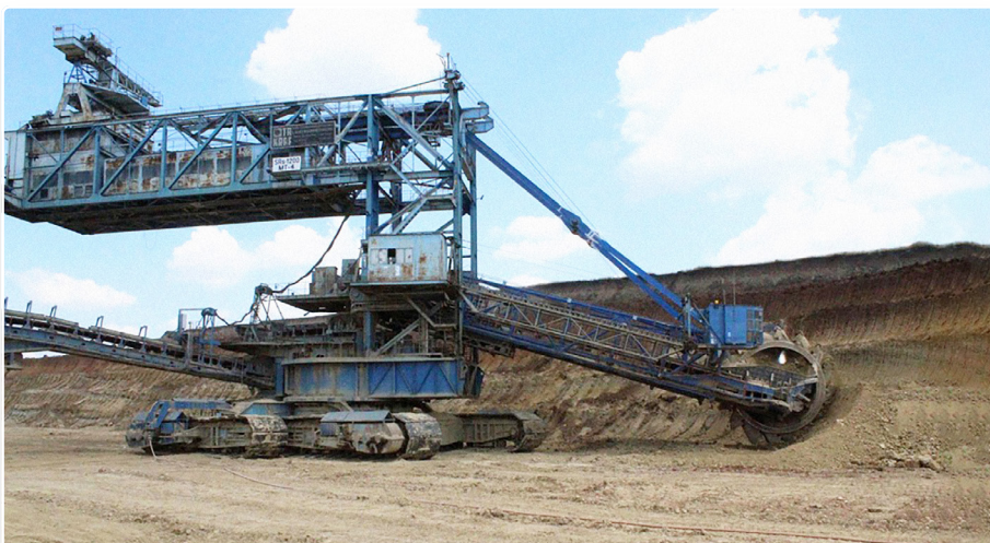
Forgókanalas kotrógép és a forgókanál munka közben
