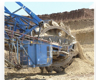
Forgókanalas kotrógép és a forgókanál munka közben
