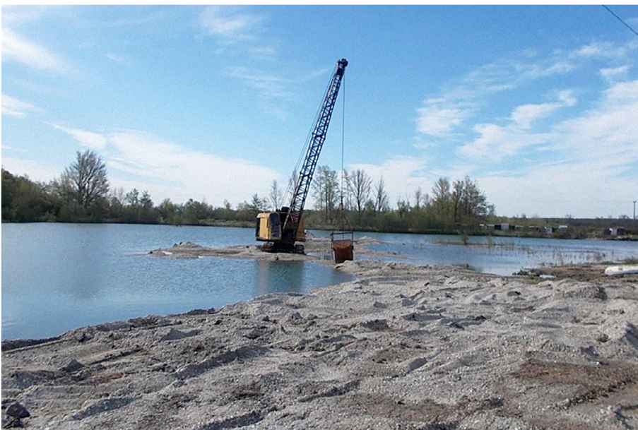
Víz alóli kitermelést végző vonóvedres kotró
