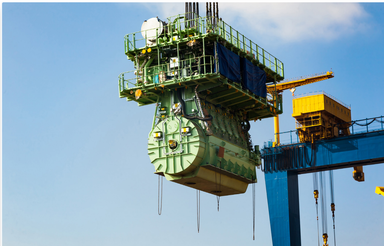
30. ábra Egy „kisebb” hajómotor beemelés közben
