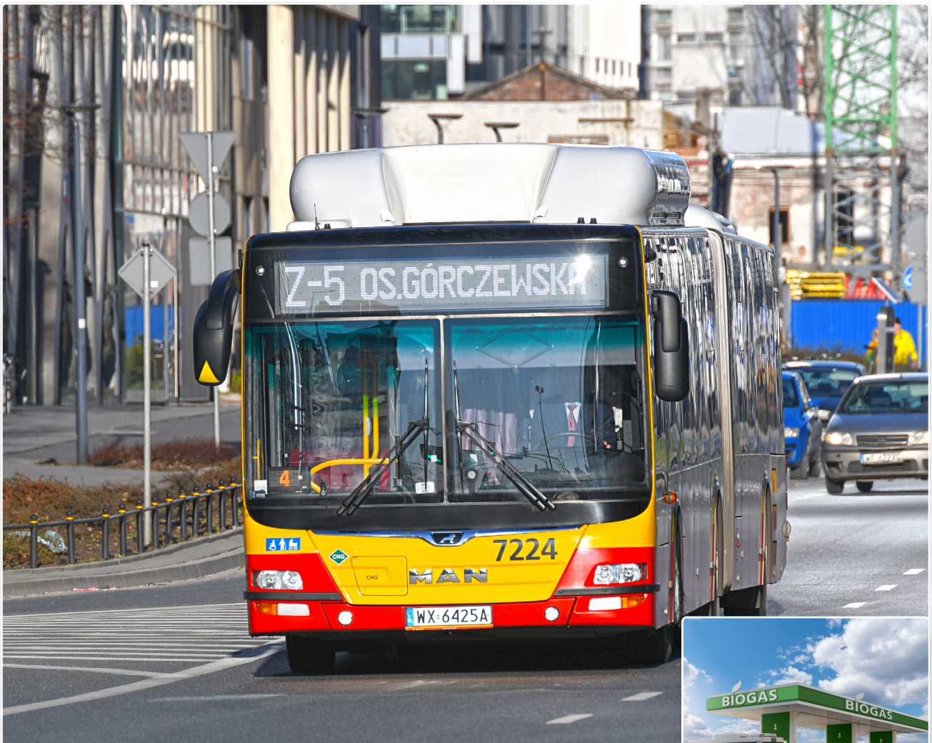
20. ábra CNG-üzemű busz a varsói forgalomban, a gáztartály a tetőn kapott helyet
